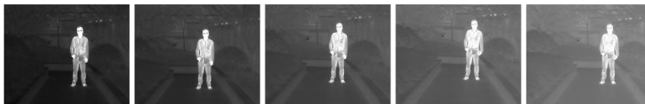
Рис. 3-1. Регулировка яркости в режиме «горячее – белое»
