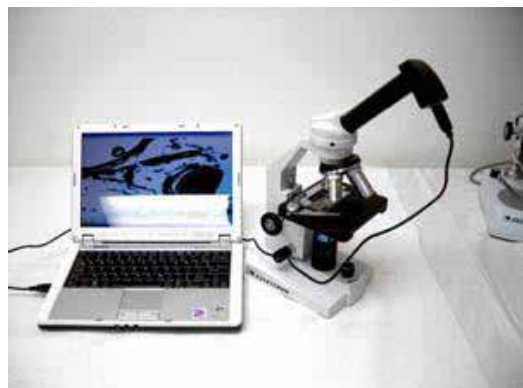
VGA визуализатор, подключенный к микроскопу и ноутбуку
