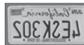
Зеркальное изображение (модели 70 и 90 с диагональной призмой)
