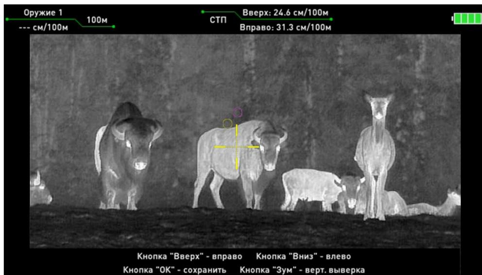
Рисунок 26 – Настройка дальномерной метки по горизонтали
