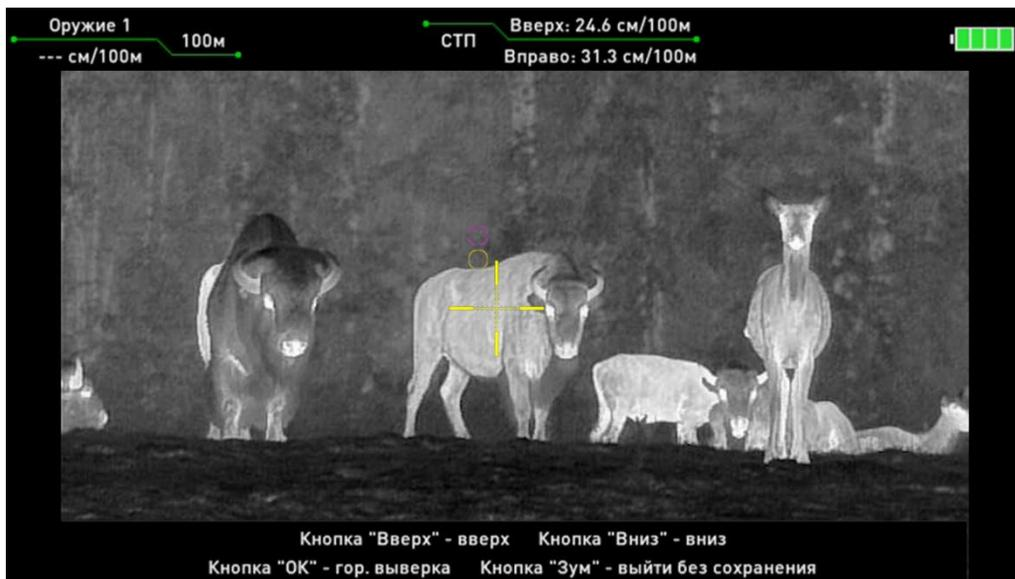
Рисунок 25 – Настройка дальномерной метки по вертикали
