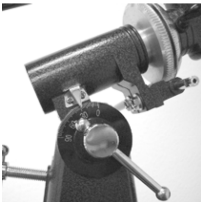
Рис.4-7: круг склонений вверх, прям. восх. - внизу
