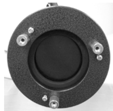
Рис. 5-2. PowerSeeker 114 EQ –оправа главного зеркала
