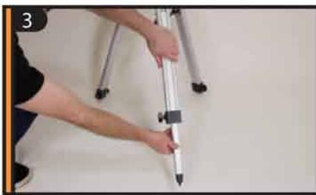
Вы можете выдвинуть секции стоек треноги до желаемой высоты. Минимальная высота треноги 66 см, максимальная 119 см. Ослабьте (вращением против часовой стрелки) фиксаторы секций опор, расположенные в нижней части опор, выдвиньте секции опор на требуемую длину и закрепите фиксаторы.
