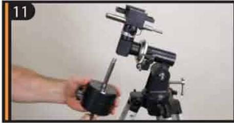
До упора вкрутите торец штанги противовеса с длинной резьбой в отверстие с резьбой на оси склонения монтировки.
