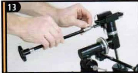
Наденьте ручку на ось прямого восхождения до упора. Закрепите фиксатор на ручке управления тонкими движениями.
