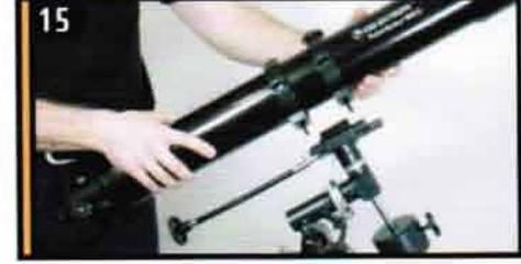
Проденьте шпильки колец через отверстия в верхней части несущей пластины монтировки.
