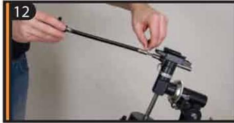
Установите ручку управления тонкими движениями по оси склонения на вал в верхней части монтировки. Закрепите фиксатор на ручке до упора.
