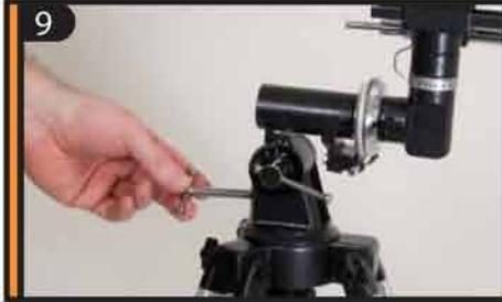
После этого установите задний винт установки полярной оси, вкручивая его до тех пор пока он не начнет поднимать монтировку.
