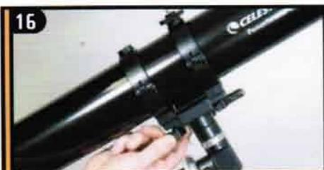
Вновь навинтите на шпильки крыльчатые гайки и крепко затяните их.
