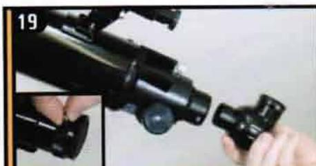
Ослабьте винты-фиксаторы окулярного узла и снимите крышку. Вставьте посадочную втулку диагональной призмы в фокусировочный узел и затените винт.
