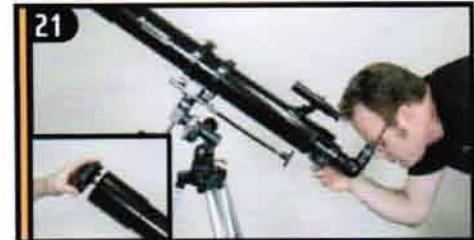
Прежде чем начать наблюдения, снимите крышку с передней части трубы телескопа.
