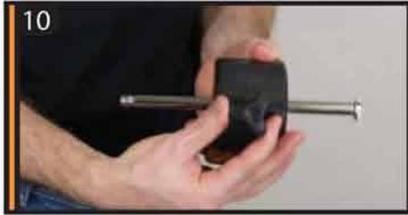
Наденьте противовес на штангу примерно на половину ее длины и закрепите положение противовеса винтом фиксатором.
