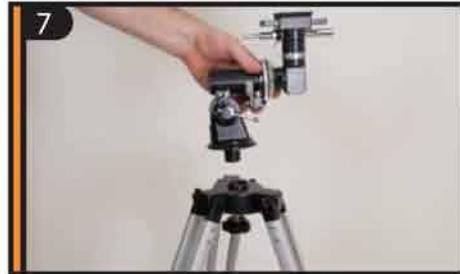
Извлеките экваториальную монтировку из коробки. Установите монтировку в центральное отверстие головки штатива.
