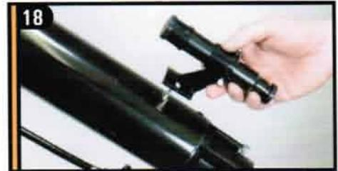
Установите крепление искателя на шпильки и закрепите его гайками. помните, что большая линза (объектив) искателя должна быть направлена в сторону объектива.
