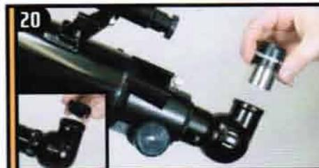
Установите посадочную хромированную трубку окуляра в отверстие диагонали и закрепите винтом-фиксатором.
