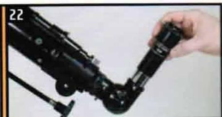
Вы можете изменять увеличение вашего телескопа при помощи сменных окуляров или линзы Барлоу. Установите посадочную втулку линзы в оборачивающую призму.
