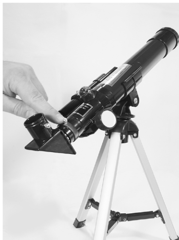
3. Установите диагональное зеркало в фокусер и зафиксируйте положение с помощью винта
