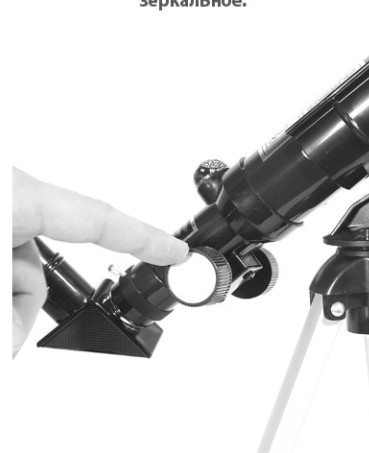
7. С помощью ручки сфокусируйте телескоп на объекте
