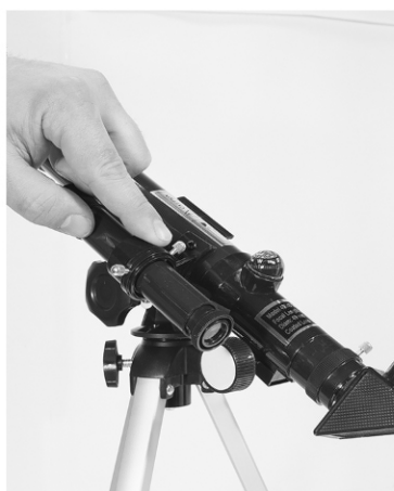
5. Наведите телескоп на отдаленный объект. Сфокусируйте телескоп (см. п. 7) с помощью винтов регулировки искателя совместите объект с перекрестием. Обратите внимание, что изображение в искателе перевернутое.
