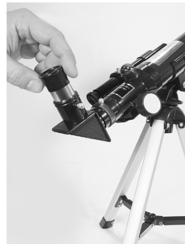
4. Установите окуляр в диагональное зеркало и зафиксируйте положение с помощью винта. Обратите внимание что изображение в телескопе будет прямое зеркальное.
