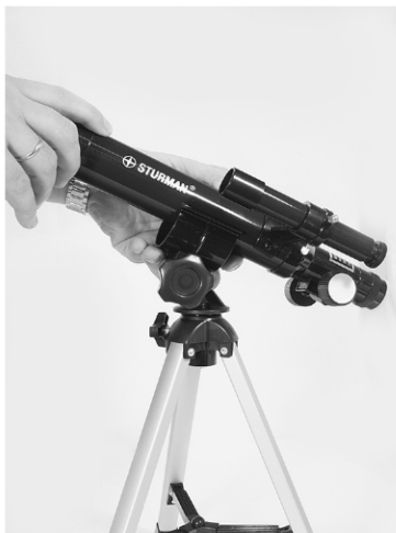
2. Установите трубу телескопа на штатив
