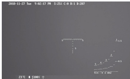
Рис. 9 Tактическая дальномерная сетка прицела
